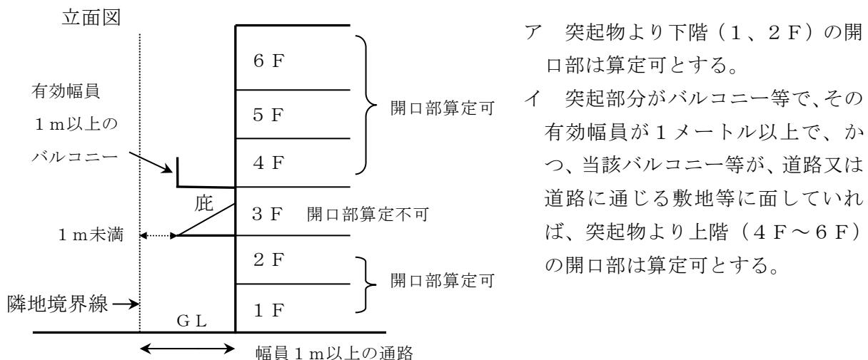
(6) 床下等で床面積に算定されている部分が存する防火対象物については、無窓階判定をする上では当該部分を外部空間として取り扱い、次の図のBの床面積で無窓階判定をすること。◆
