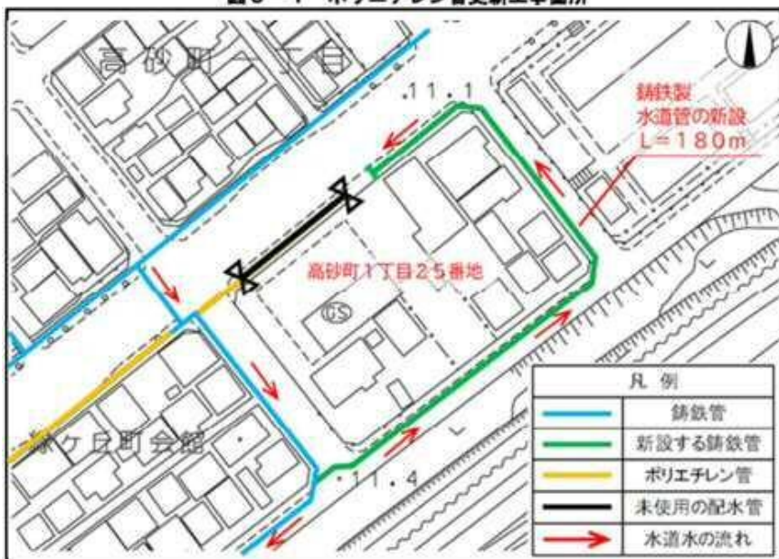
図3-1 ポリエチレン管更新工事箇所
