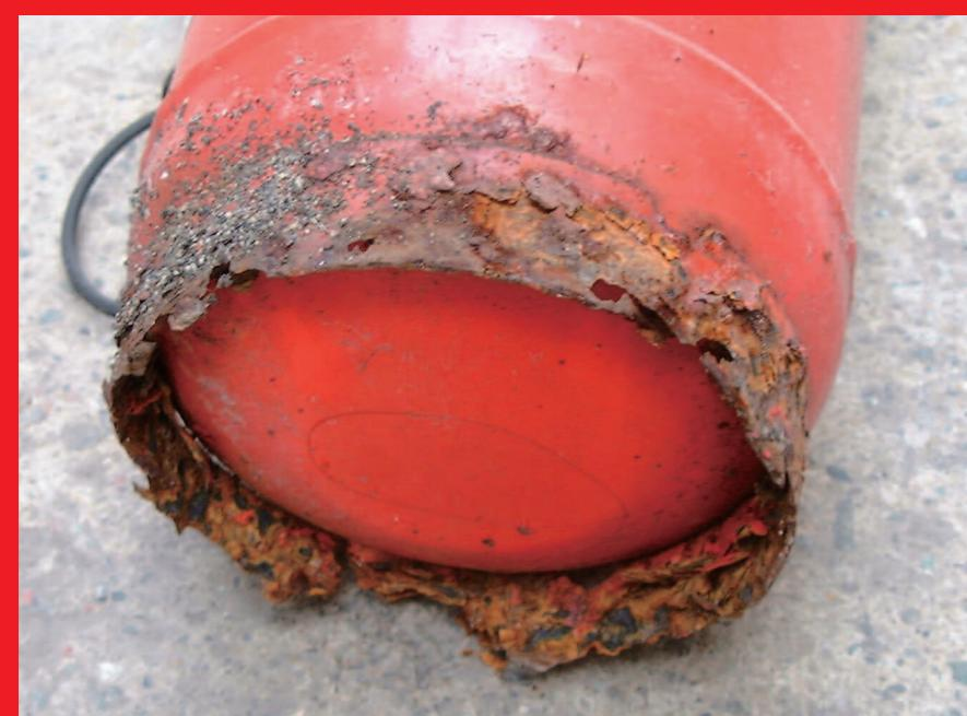
屋外に設置された消火器は、本体下部より腐食が進むことがあります。溶接部とその周辺や層状はく離の腐食などが代表的な下部の腐食です。この他にも、使用に耐えない鋭いキズや、サビを落としても腐食の残るものには危険です。
