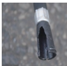
× ノズルの破損
