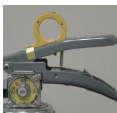
× レバー支えの脱落
