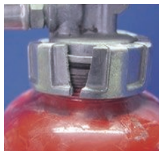
× キャップの破損
