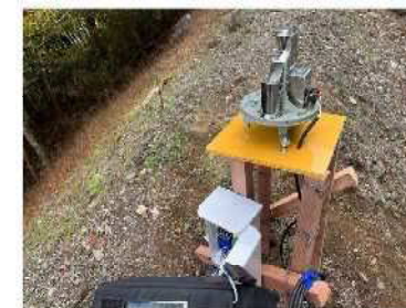
雨量計設置状況
