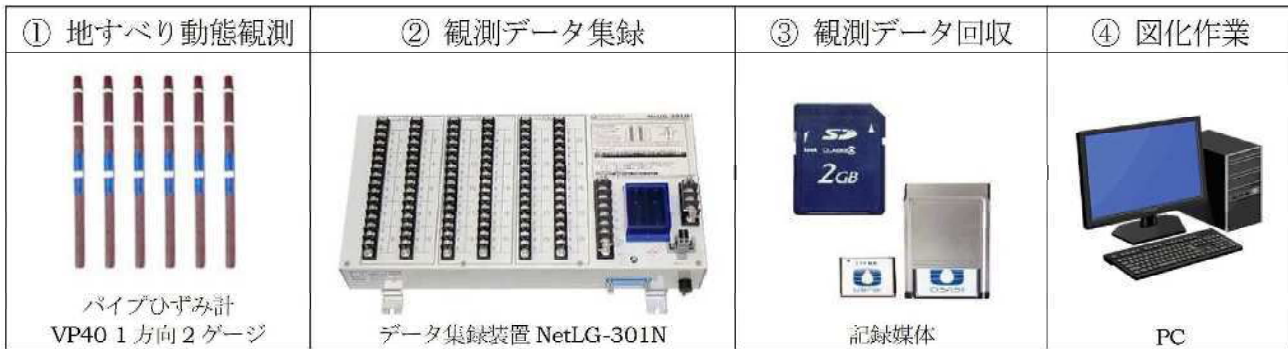
図 6. 2 パイプ歪計半自動観測概念図
