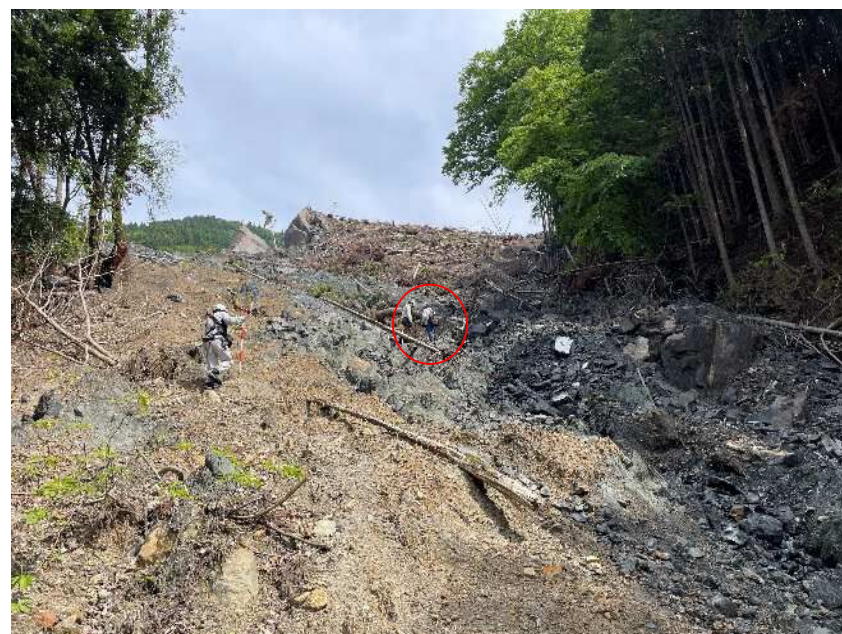
写真④ 地すべり土塊 風化した蛇紋岩の堆積物 湧水 比抵抗値 25\Omega \cdot m
