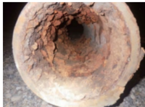
老朽化した水道管の内部 古い管は、漏水事故の原因にもなります。
