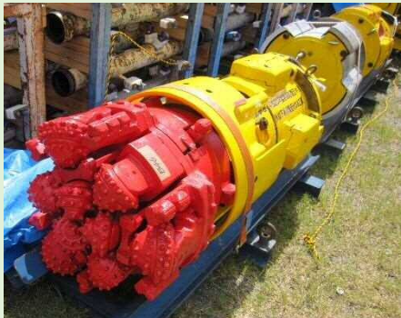
(写真3:推進機(掘削機械))
