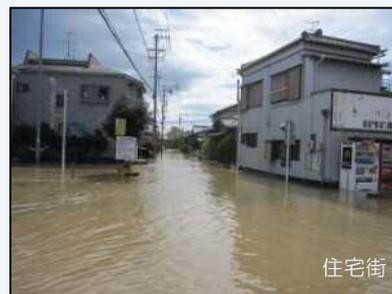
対策がなされていないため、放流先河川の水位の影響により排水できない
