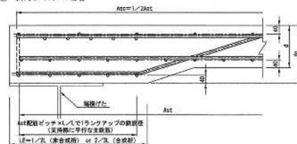
図 2.5.3 けた端部の構造 (2)
