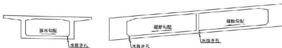
図 1.3-6 水抜き孔の設置例
