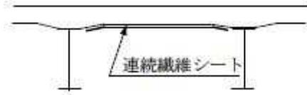
図-7.4.2 連続繊維シート接着工法の例
