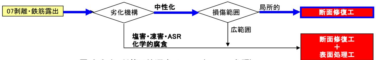
図-9.6.4 対策工法選定フロー (p.5-15 参照)
