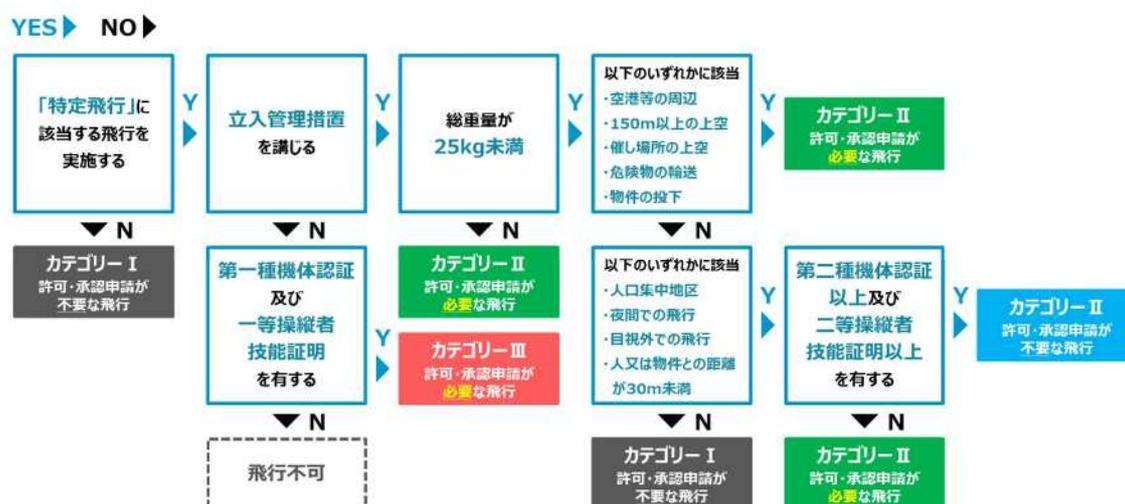
図 4-3. 飛行カテゴリー決定フロー図（国土交通省 HP）
