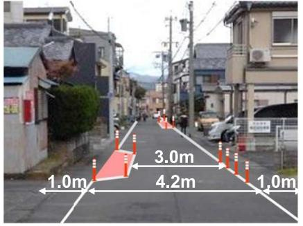
C-2車両走行位置の明確化(外側線の設置)
