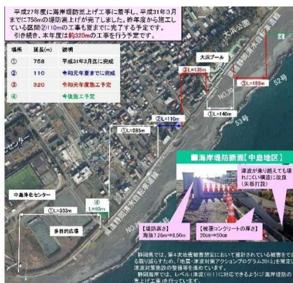
図4 静岡海岸の堤防嵩上げ工事の進捗
