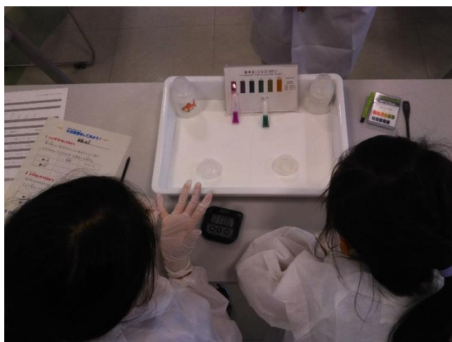
パックテストは水が変色することで判定を行います。写真では比色表とパックテストを対比させています。
