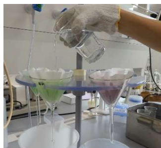
ポリアミドを温水で洗浄し 色素以外の成分を取り除く
