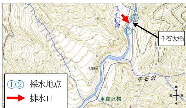
調査地点図 (千石宿舎付近)
