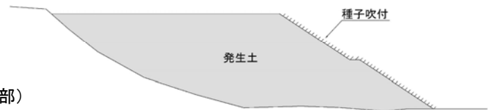
図 発生土置き場における施工概要
