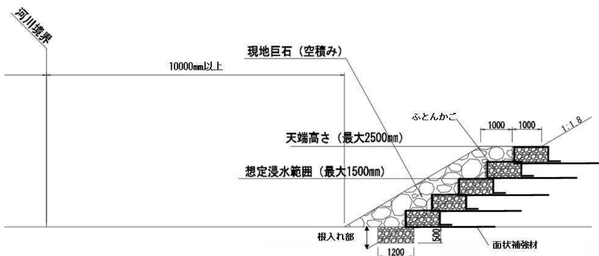
図 3 4 盛土のり尻構造物詳細図
