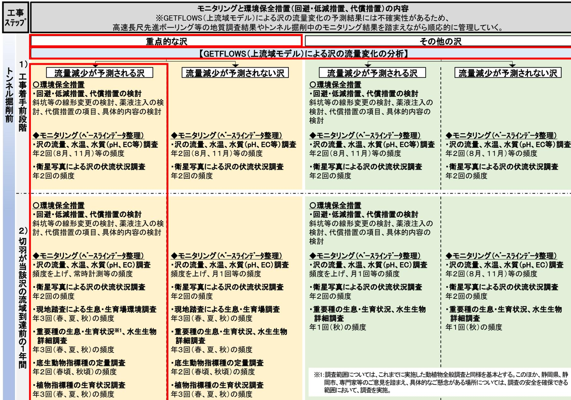
図 2 沢におけるモニタリングと環境保全措置のフロー【1) 工事着手前段階、2) 切羽が当該沢の流域到達前の1年間】
