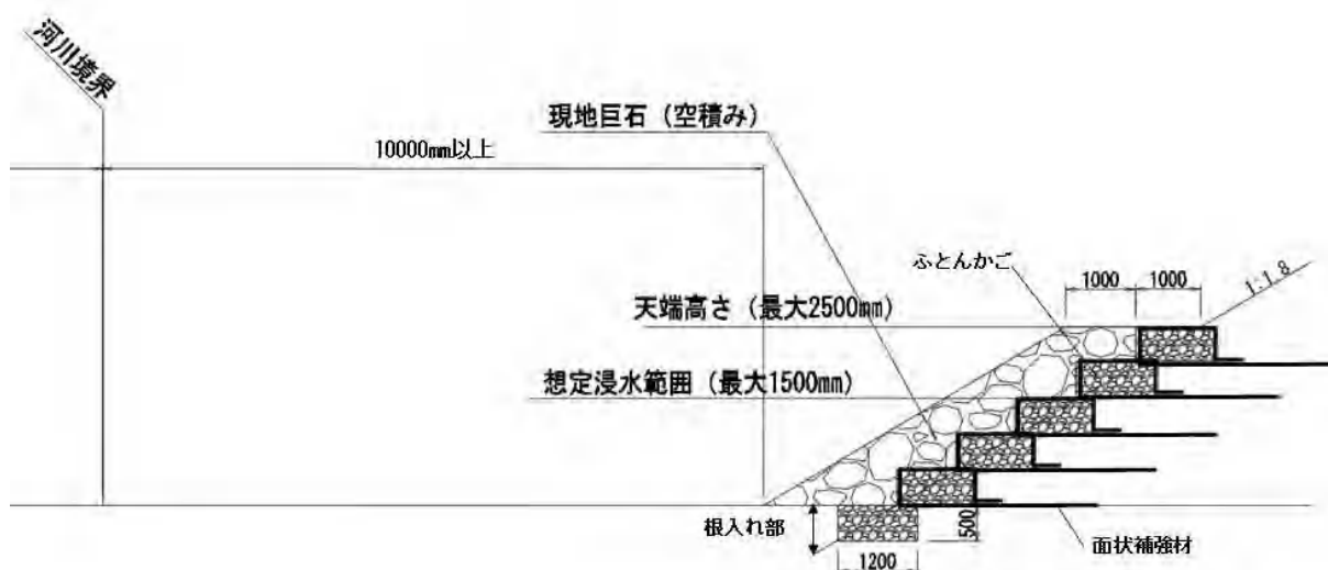
図 30 盛土のり尻構造物詳細図
