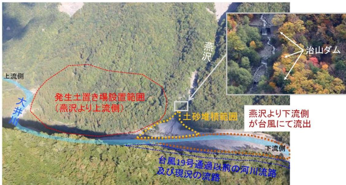
図 3 燕沢の土砂堆積範囲と発生土置き場設置計画範囲
