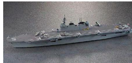
最新鋭艦「いずも」をウォーターラインでキット化! 幅約38.9cm×高さ約13cm×奥行約7cm 全長248m、基準排水量19,500t、海上自衛隊史上最大の大きさを誇るヘリコプター搭載護衛艦を精密に再現。キットは「精密さ」と「組み立てやすさ」の両立を目指したバージョン構成です。船体は前/左/右/後/底の分割式で、桁を挟み込みながら組み上げる設計。艦橋はスライド金型を使用することにより少ないバージョン数で複雑な形状を再現。大面積の全通甲板は、エレベーターを外した一枚板の状態でバージョン化しており、後部のテッキサイド式エレベーターの取り付けは上/下の状態を選択可能です。
