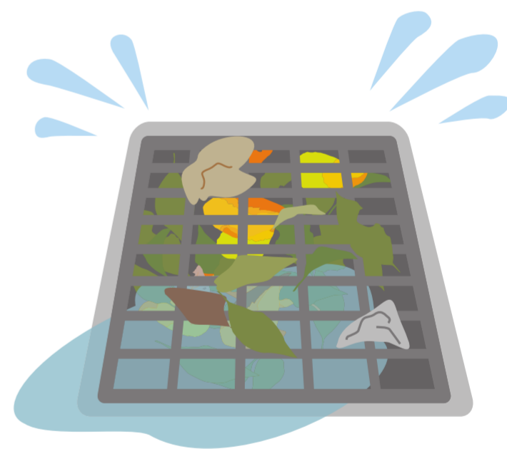
詰まった排水溝
