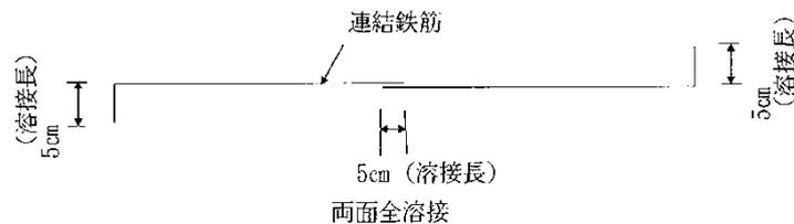
図2-7 コンクリートブロックの鉄筋継手
