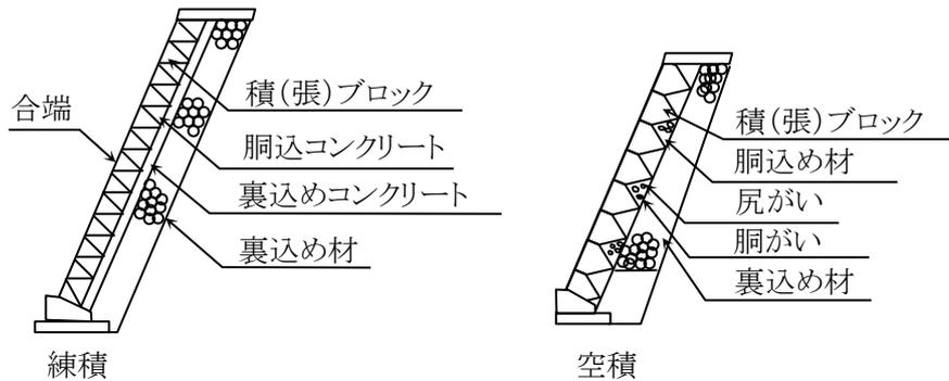
図2-6 コンクリートブロック工
