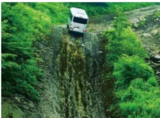
◀完成車両での走行実験では、傾斜角度30度の斜面、水深60cmの河川でも走行可能であり、その他、普通であればスタックする砂地も走破でき、雪道でもチェーンを装着せずに走行可能です。
