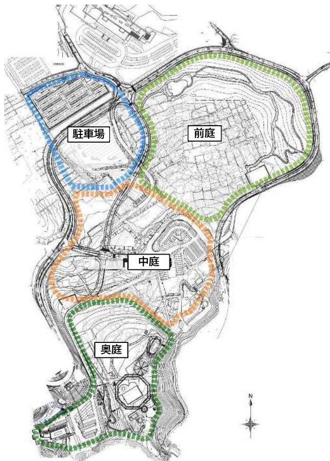
駐車場は、山頂部からの景観に配慮してアプローチ道路西側の北端に配置。立体構造とし、施設規模を抑制
