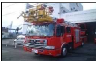
大型高所放水車
