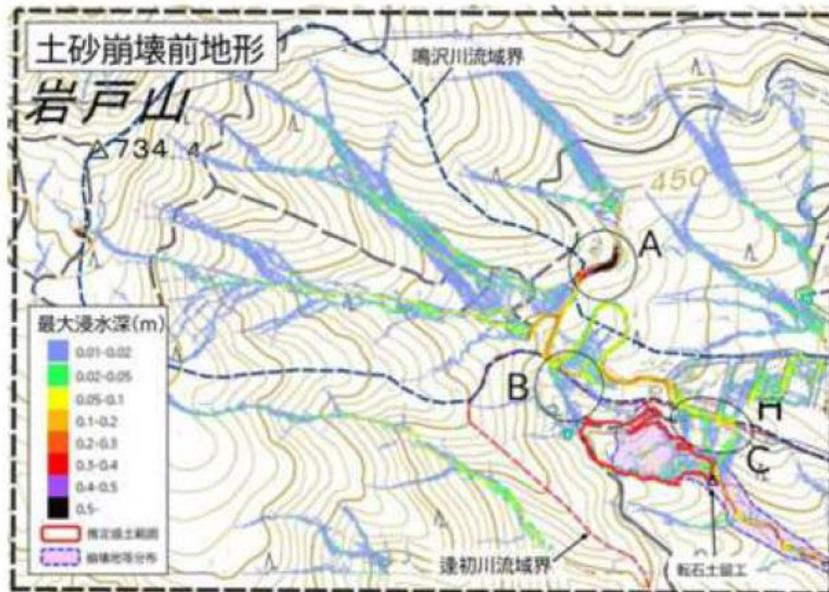
図 5-32 最大浸水深分布（土砂崩壊前地形）
