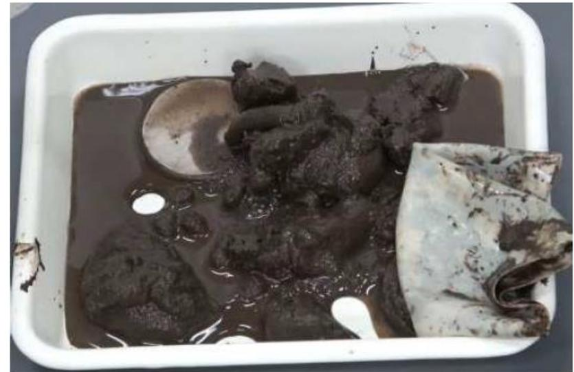
図 7-29 吸水軟化試験後の流動化した状態の供試体
