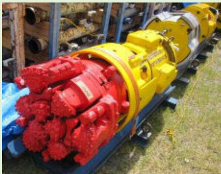
(写真3:推進機(掘削機械))
