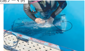
光ToFイメージセンサによる水中観測実験
