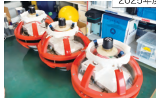
音響測位ビーコンを活用した海洋測位システム
