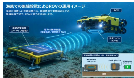
図1 海中給電システムイメージ図
