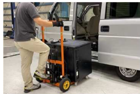
可搬型蓄電池交換の様子
