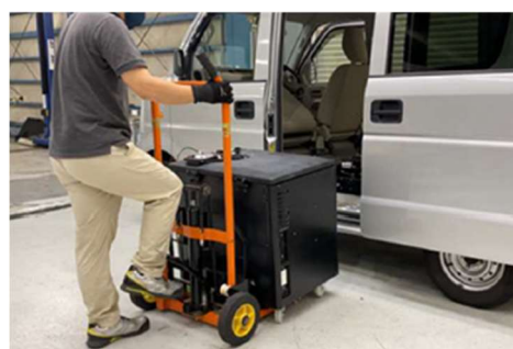
可搬型蓄電池交換の様子
