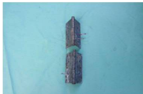
写真 30 蝶番の焼損の状況
