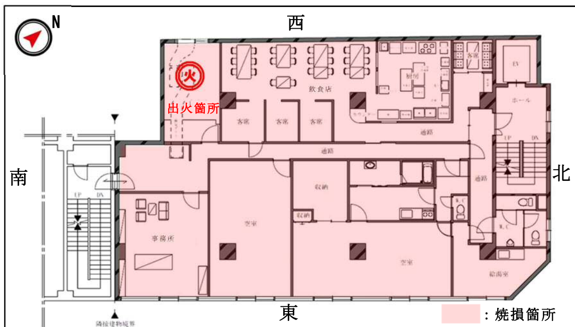
図4 焼損状況及び出火箇所
