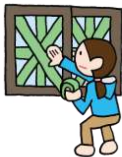
窓ガラスを補強する
