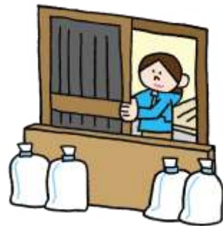
止水板を設置する
