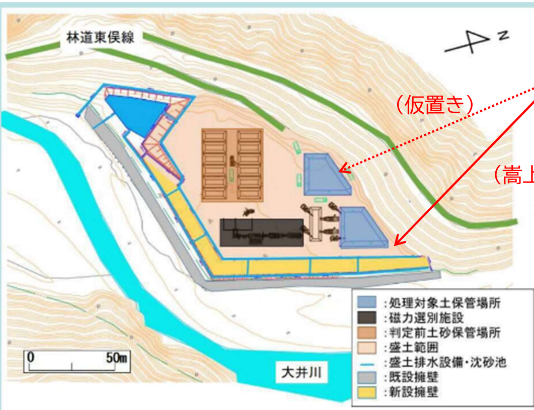
中ノ宿3発生土置き場におけるオンサイト処理施設イメージ
