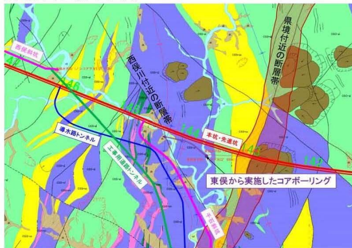
図 14 東俣から実施したコアボーリングの位置
