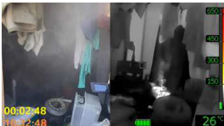
着火から約 3 分後(左：ビデオカメラ映像、右：熱画像直視装置映像)
