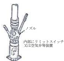
第10-70図 ノズル格納装置による方法の例
