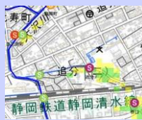
巴川浸水情報システムの画像 (現時刻の浸水箇所を着色により表示)
