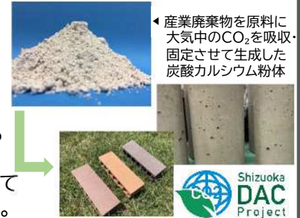
▲CO 2 を固定した粉体をコンクリートの材料や炭酸カルシウム代替品として再製品化する
