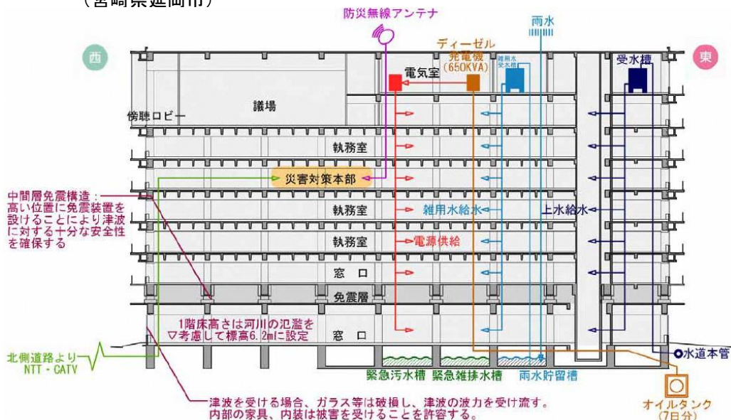
庁舎における業務継続機能の事例 (宮崎県延岡市)
