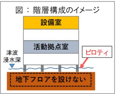
※ピロティ形式とは、柱のみから成る高い開放性をもつ構造形式で、外壁を設けないため津波が通り抜け、津波による建物の転倒等を防止する効果があります。
