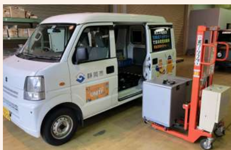
②LEALIAN 社製2人乗りEVと可搬型バッテリー
