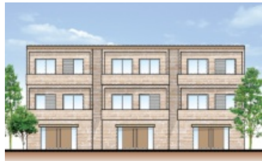
単調な壁面とならないよう、バルコニー等により壁面に凹凸を設けることで沿道に与える圧迫感を軽減しています
