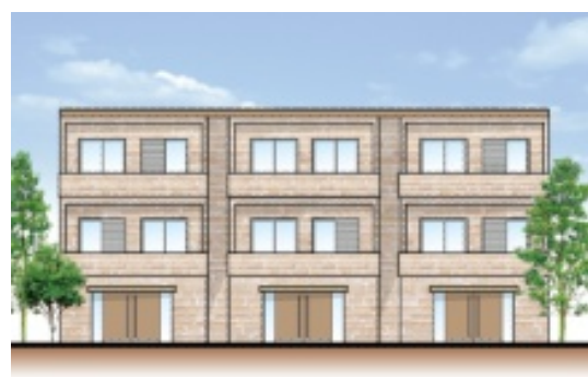
単調な壁面とならないよう、バルコニー等により壁面に凹凸を設けることで沿道に与える圧迫感を軽減しています
