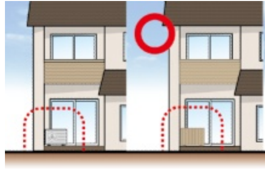
建築物の外壁や周辺景観と調和するよう、室外機を木調のルーバーで遮蔽しています
