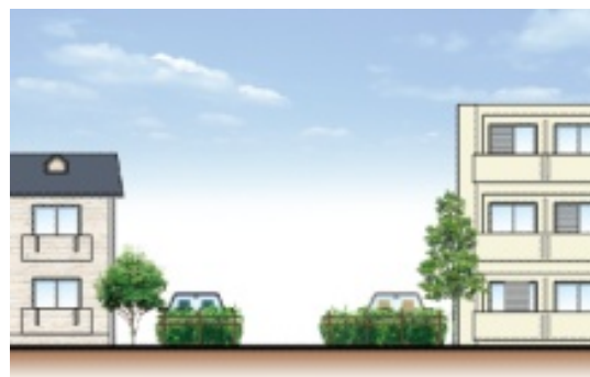
道路に面した駐車場の車の目隠しとなるよう、道路境界部に生垣を設けています
