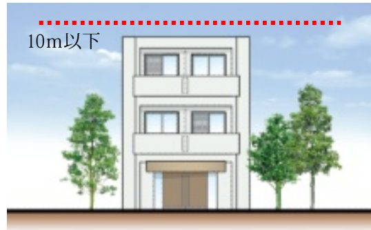
周辺の建築物との調和を図るため、建築物の高さを10m以下としています
