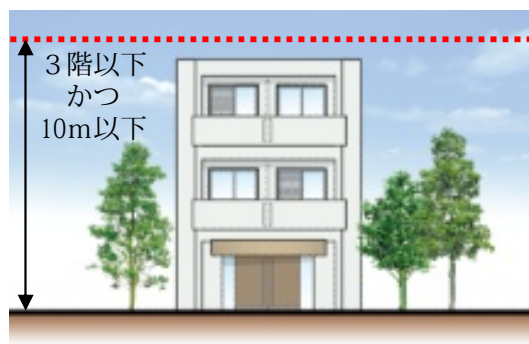
周辺の建築物との調和を図るため、建築物の高さを3階以下かつ10m以下としています
