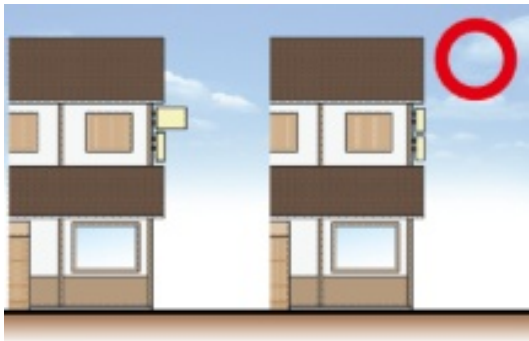
すっきりとした沿道景観になるよう、片側に集約し、出幅を揃えています
