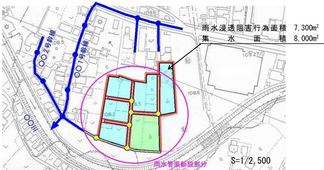
図 6-5 排水施設計画平面図の例
