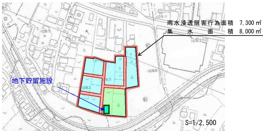
図 6-6 対策工事位置図の例
