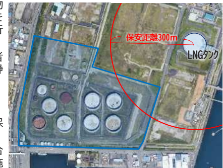
図：既存LNGタンクからの保安距離
